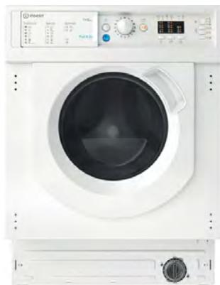
Indesit BI WDIL 751251 EU N. Tipo di carica: Caricamento frontale, Posizionamento dell'apparecchio: Da incasso, Colore del prodotto: Bianco. Capacità di asciugatura: 5 kg, Velocità di centrifuga massima: 1200 Giri/min, Classe di efficienza della centrifuga: B. Classe di efficienza energetica (lavaggio): E, Classe di efficienza energetica (lavaggio e asciugatura): F, Consumo di acqua (lavaggio): 55 L. Profondità: 545 mm, Larghezza: 595 mm, Altezza: 815 mm
